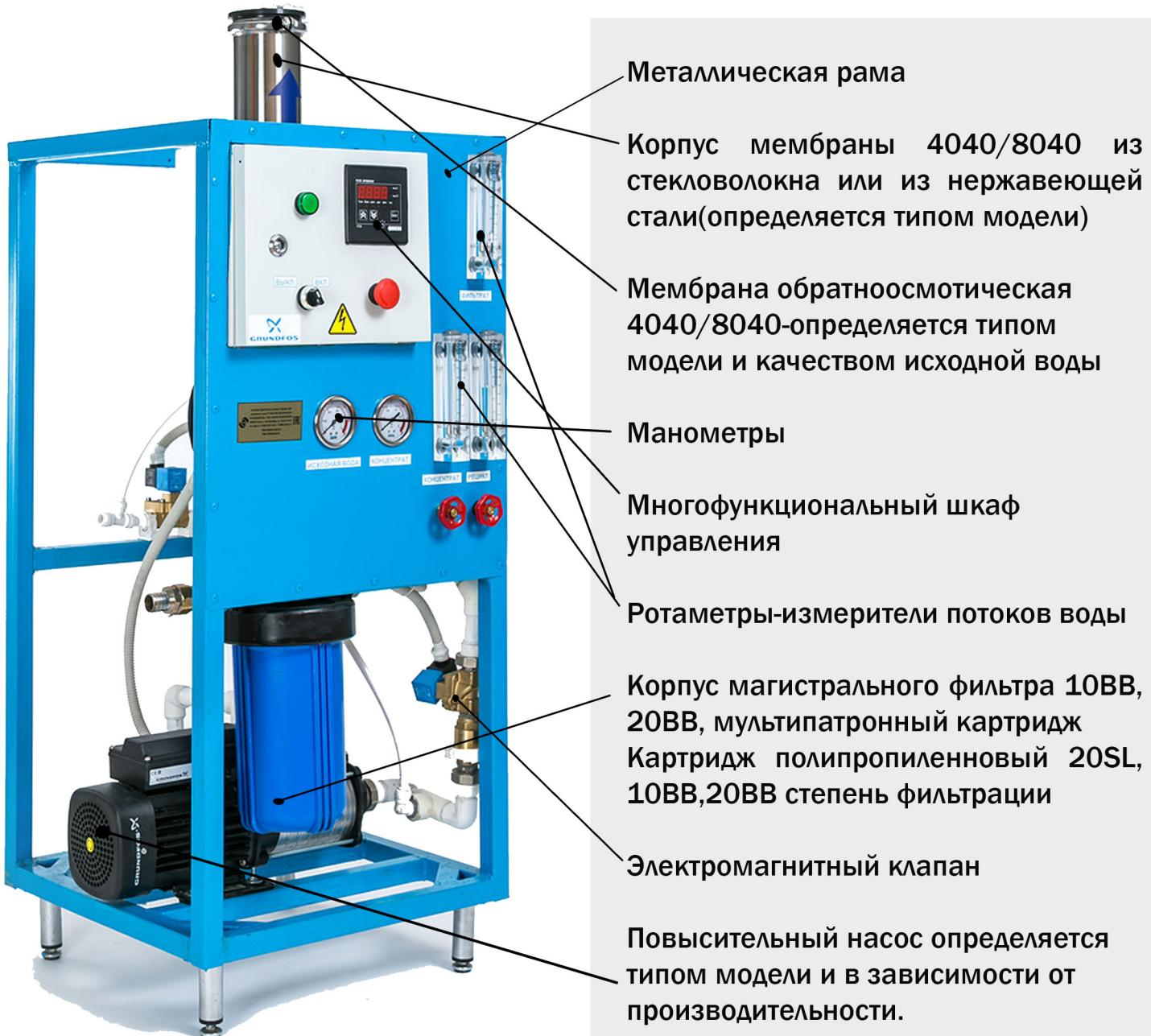
Рис. 2 – Установка орошения морской воды
